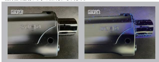
・接着剤の塗布漏れ確認検査
