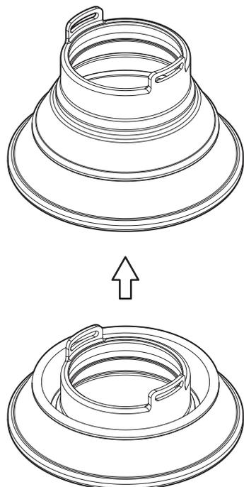
(2) フードの端を引っ張りながら (1)、反対側の端にライトを掛けて (2) ゆっくりと挿入する (3) と取り付けやすいです。奥までしっかりと差し込んで取り付けてください。付属の落下防止用のバンドをかけてください。
