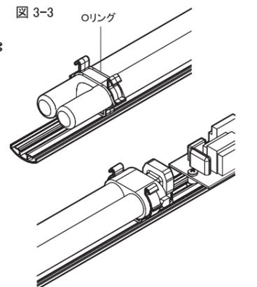
4. 先端側エンドキャップの切り欠き差し込むようにして外筒を被せて、コード側エンドキャップをはめてください。
